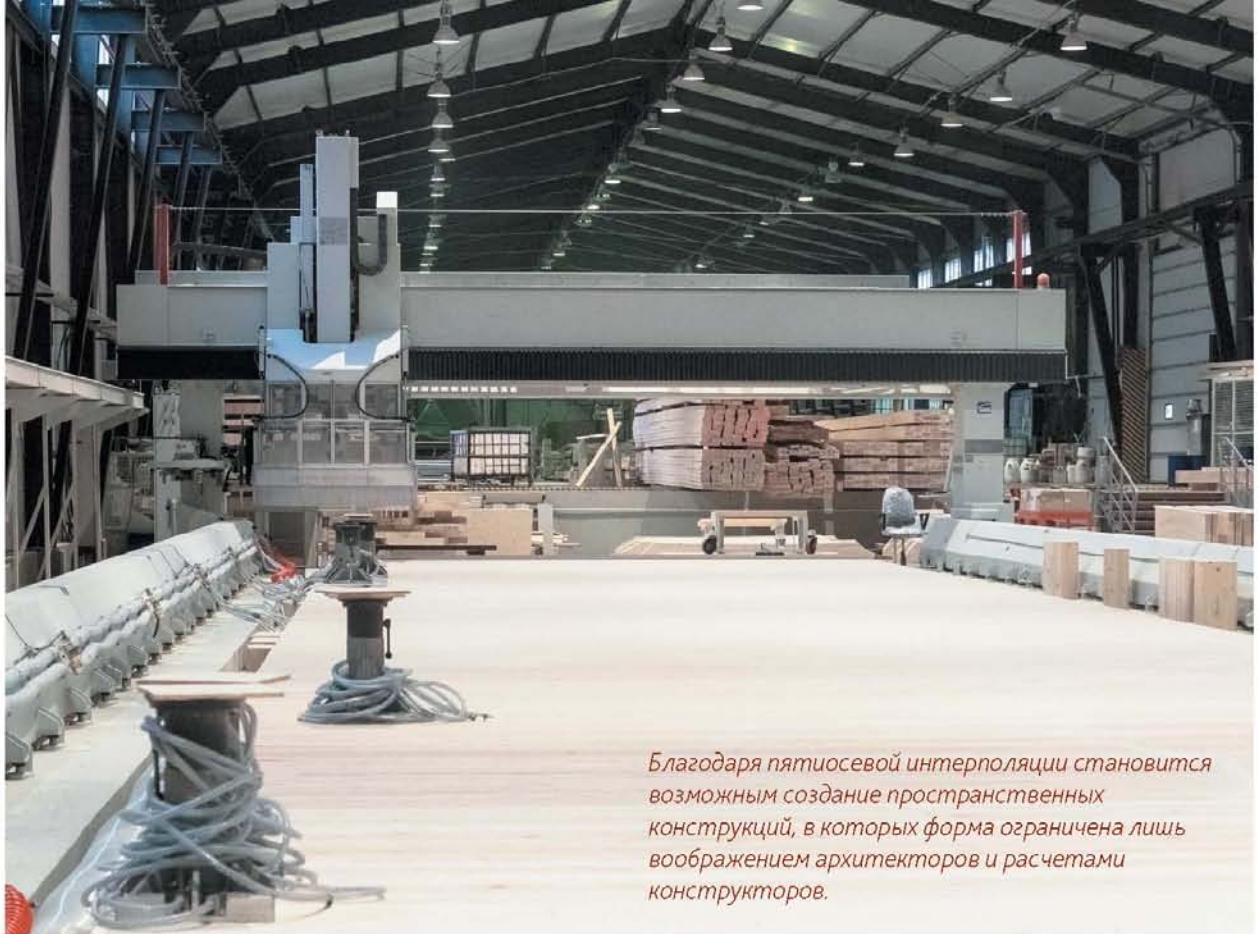
*Благодаря пятиосевой интерполяции становится возможным создание пространственных конструкций, в которых форма ограничена лишь воображением архитекторов и расчетами конструкторов.*
